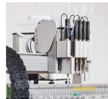
BSyS打印头, 配置有用于生产胶原蛋白凝胶的塑料针头和毛细管喷嘴
