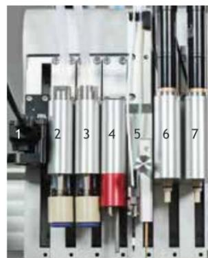
打印头(示例)带有(1)相机、(2+3)夹具/3腔移液器、(4)Flip Tube 开盖器、(5)压电喷头+Z传感器、(6+7)抛弃式针头或钢针
