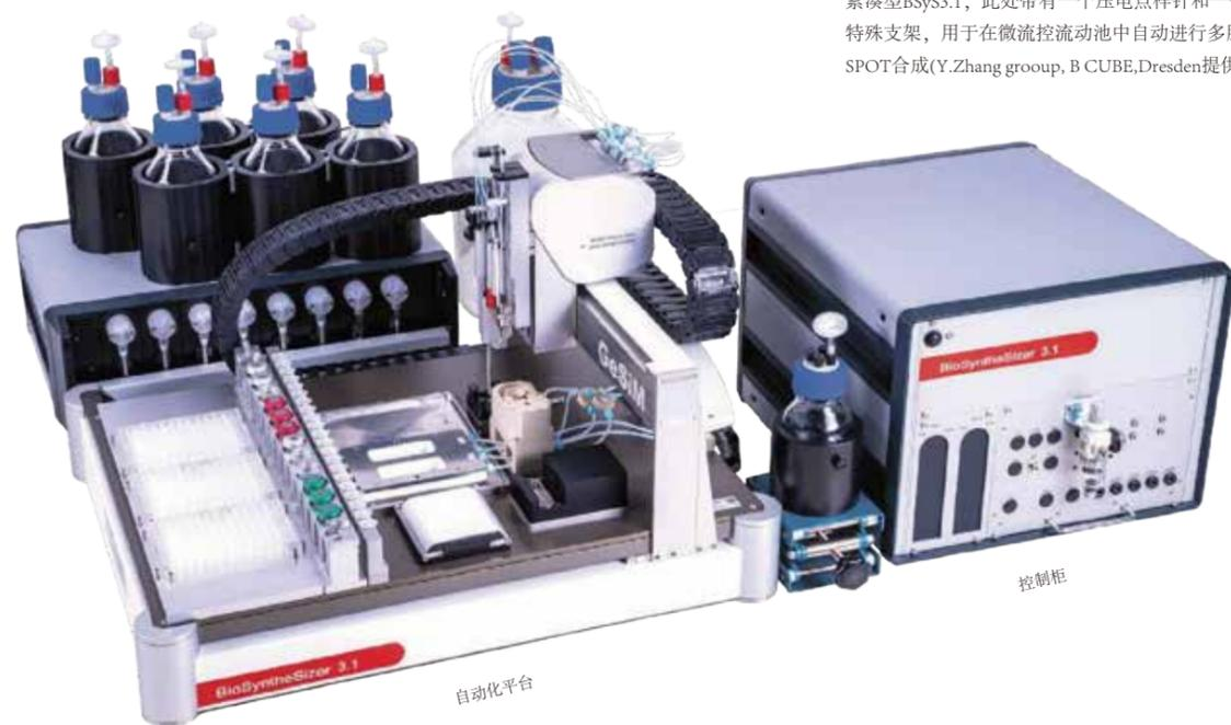
紧凑型BSyS3.1, 此处带有一个压电点样针和一个特殊支架, 用于在微流控流动池中自动进行多肽SPOT合成(Y.Zhang group, B CUBE, Dresden提供)
