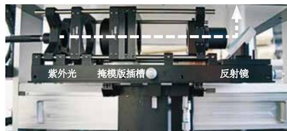
紫外光学准直光刻系统（外壳已移除），装配于 $\mu$ CP6.x的下层平台上，可在Y轴方向独立运动，X轴与上层打印头联动。带XYZ微调旋钮，可切换掩模板
