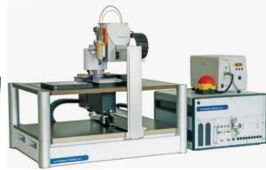
双层 $\mu$ CP6.1平台, 高速直线电机驱动。下层Y轴装配了一个紫外准直光刻系统, 可装配光刻掩模版, 用于精确控制曝光区域, 尤其适用于UV-NIL (见后页)。上层Y轴可装配多个打印工具, 可根据需要自定义设备配置。
