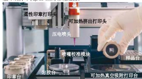
工作台模块：印章台、匀胶台（例如用于印章上墨，带有印章高度传感器）、用于4英寸衬底的可加热真空吸附打印台（最高120°C），喷嘴校准模块。如配置压电打印功能：清洗/干燥站、频闪模块，样品台。
