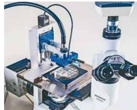
$\mu$ CP Core, 入门级微接触印刷打印模块, 上图配置为大印章和UV光纤, 位于倒置显微镜上(显微镜不属于配置内, 控制柜及外置紫外光源未展示)
