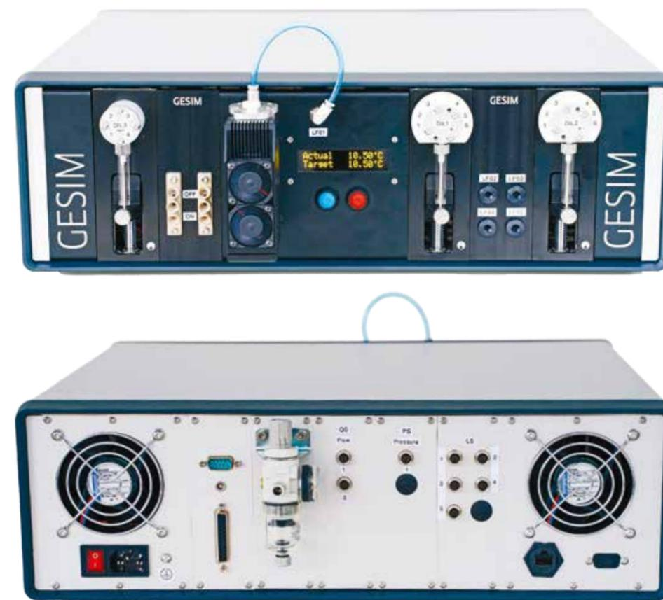
流体控制器有最多十个从前面接入的模块（最多七个从后面接入）。在这里您可以看到一个带有三个注射泵的设备（配有选择器/分配器），两个3/2通阀门、气动挤压模块（4-80°C），以及隔膜泵的入口/出口，用于大体积液体转移。
